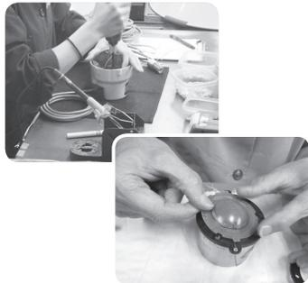
音を発生させる振動板の組み立ては、手作業による非常に高精度な作業です。
