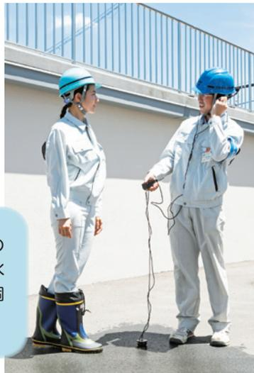
埋設されている水道管からの漏水が疑われるときは、漏水探知機を地面に当て、漏水個所を探します。
