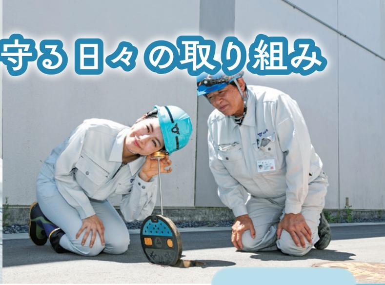
水道管の状態を調べるため、点検する管に音聴棒の先を当て、異音がないか確認します。
