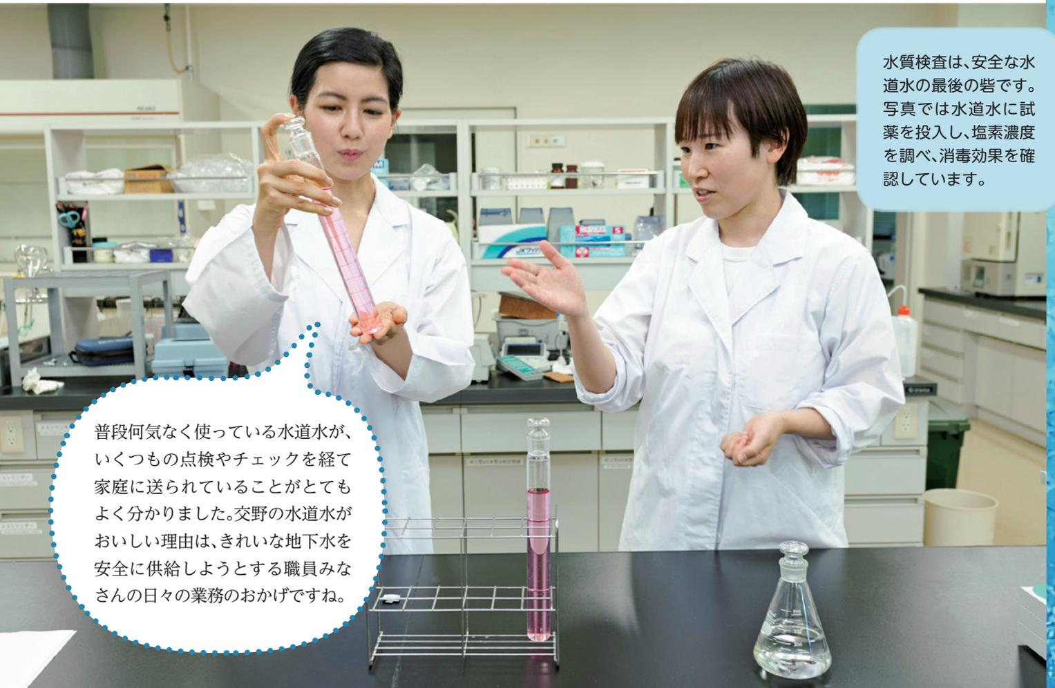
水質検査は、安全な水道水の最後の砦です。写真では水道水に試薬を投入し、塩素濃度を調べ、消毒効果を確認しています。
